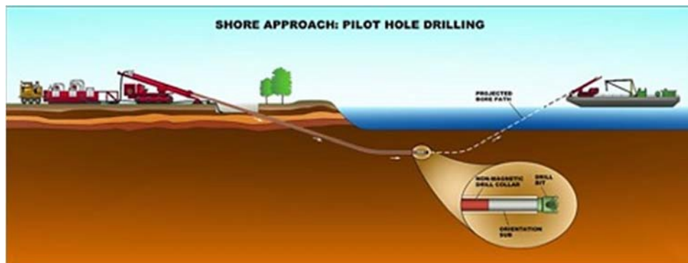
Figura 7.4: posa del cavo nel punto di sbarco con tecnica TOC
