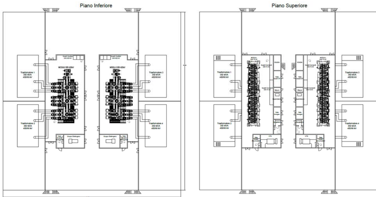
Figura 4.4 pianta elettromeccanica della Stazione Elettrica galleggiante
